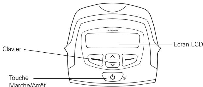
Le panneau de contrôle de votre VPAP comprend un écran LCD, qui permet d'afficher les menus et les écrans de traitement, ainsi qu'un clavier pour la navigation dans les menus et pour le traitement. Le clavier comprend les touches suivantes :
