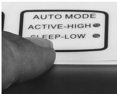
Active-High (actif-élevé) et Sleep-Low (repos-faible), qui s'adaptent automatiquement en fonction des besoins en oxygène (ex. rythme respiratoire). Aucune action n'est nécessaire pour activer la libération de l'oxygène.
