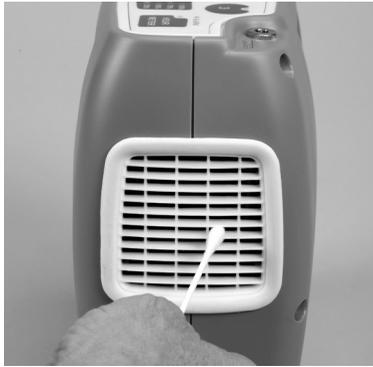
Contrôlez la grille de l'entrée d'air au moins une fois par mois ; si elle est sale, utilisez un coton-tige sec (de type Q-Tip®) pour la nettoyer. N'utilisez jamais d'alcool, de solvant ou de distillat du pétrole pour le nettoyage.
